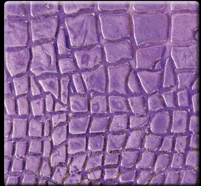
429 F (DORATO - GOLDEN - DORÉ - DORADO) CC 228 (LT. 0,300) + COLORI COL. 429 (24 ML.) — CC 228 (LT. 1) + COLORI COL. 429 (80 ML.)
